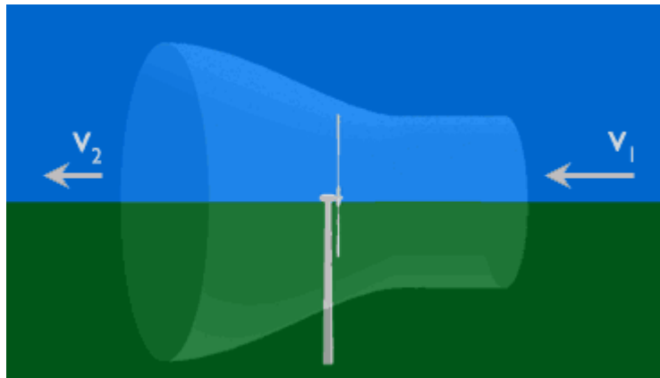
Figura 2: Demostración de la ley de Betz
