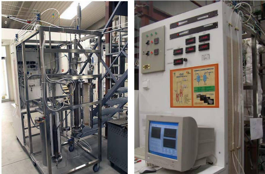
Figura 2.12. Diferentes vistas de la planta piloto CLR de 900 W t .
