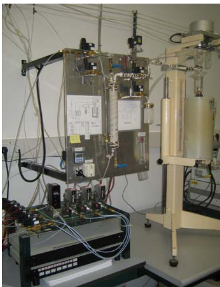
Figura 2.2. Imagen de la instalación de la TGA
