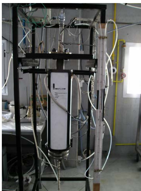
Figura 2.5. Esquema e imagen del reactor de lecho fluidizado discontinuo.
