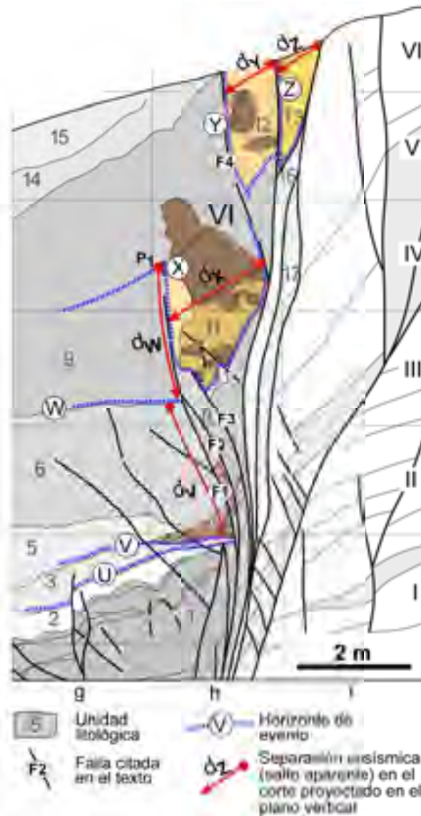
Fig. 18.7. Detalle del log de la trinchera donde se muestran las separaciones utilizadas para calcular los vectores de desplazamiento.
