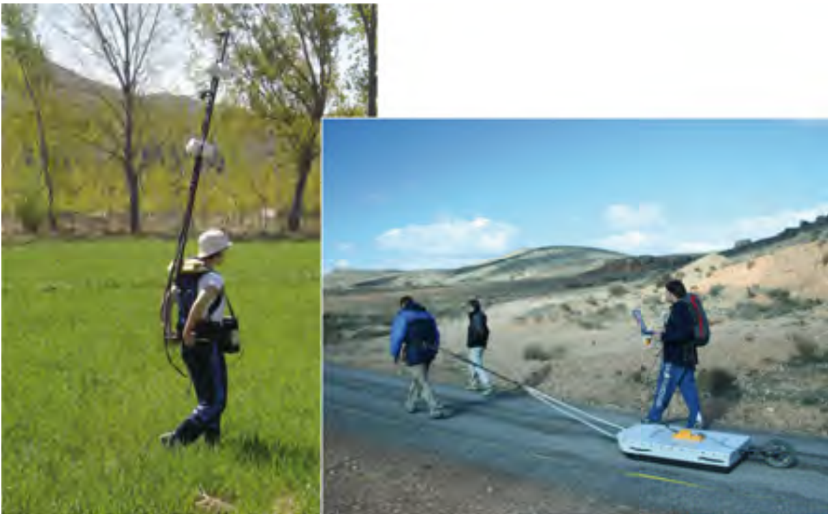
Fig. 4.1. Prospección con magnetómetro de efecto Overhauser (GSM-19) en la llanura de inundación del río Alfambra (izquierda) y mediante GPR en el área de Los Baños utilizando antena de 100 MHz (derecha).
