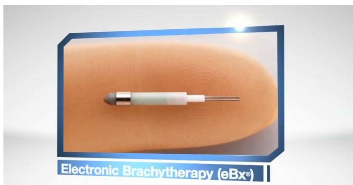
Figura 8: Fuente de RX miniaturizados en relación con una huella dactilar. [Cortesía del Hospital Universitario Miguel Servet]
