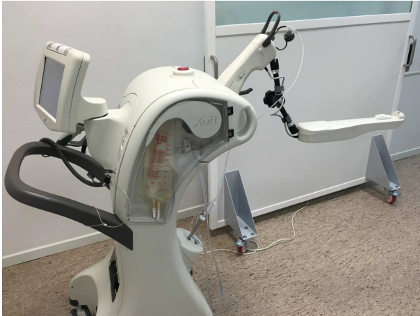
Figura 10: Equipo de RX miniaturizados con ordenador y fuente integrados en el mismo (casa comercial Xoft). [Cortesía del Hospital Universitario Miguel Servet]
