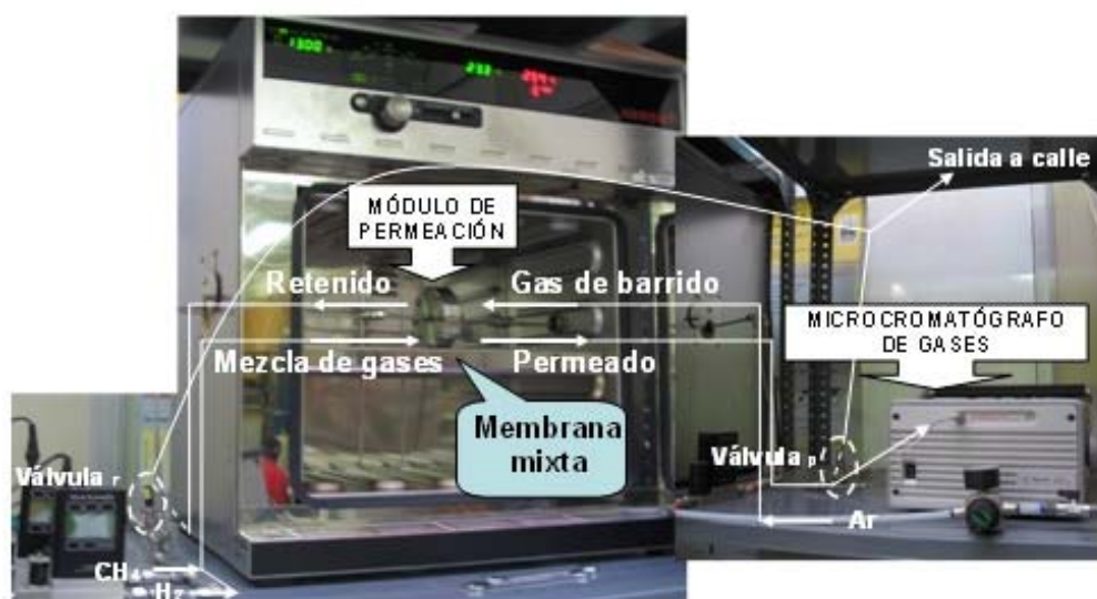
Figura 3.17. Equipo de permeación para la separación de mezclas gaseosas en la Universidad de Zaragoza.
