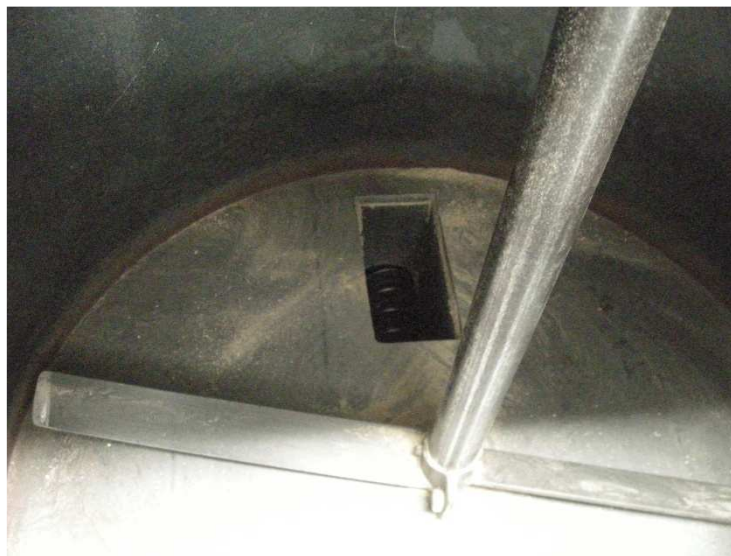
Figura 3.16. Paletas giratorias y tornillo "sinfín".
