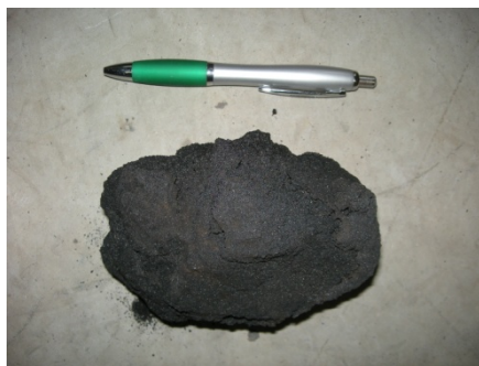
Figura 4.24. Aglomeraciones encontradas en el lecho tras el experimento 3.
