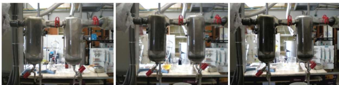
Figura 3.23. Sistema de condensación de alquitranes.
