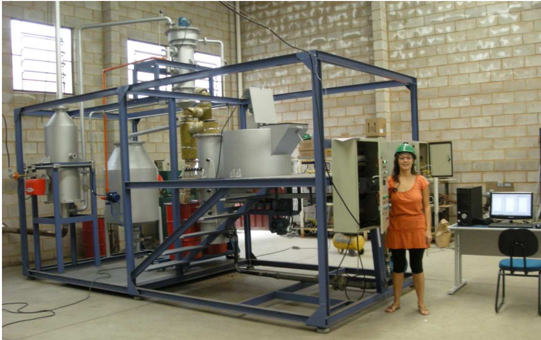
Figura 3.28. Planta piloto con reactor de lecho fluidizado.
