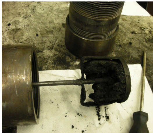
Figura 4.13. Aglomeración del char en el reactor de lecho agitado mecánicamente.
