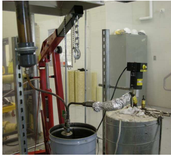
Figura 3.25. Planta experimental con reactor de lecho agitado mecánicamente.
