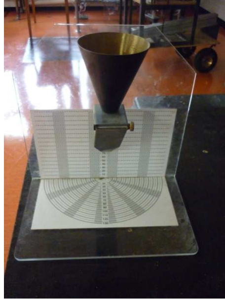
Figura 3.3. Equipo para medir el ángulo de reposo de una muestra. "Angle of repose tester".
