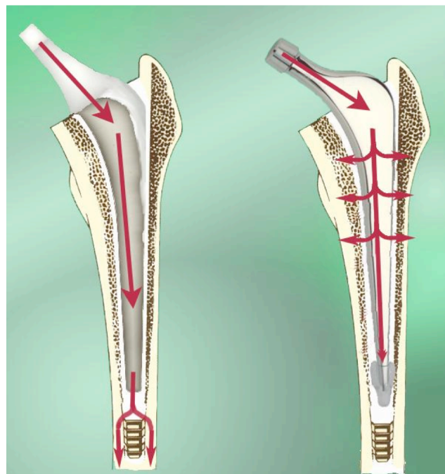
Figura 4: Transmisión de fuerzas desde el vástago al hueso según la filosofía de cementación: barra compuesta (izda) y cónico-deslizante (dcha).
