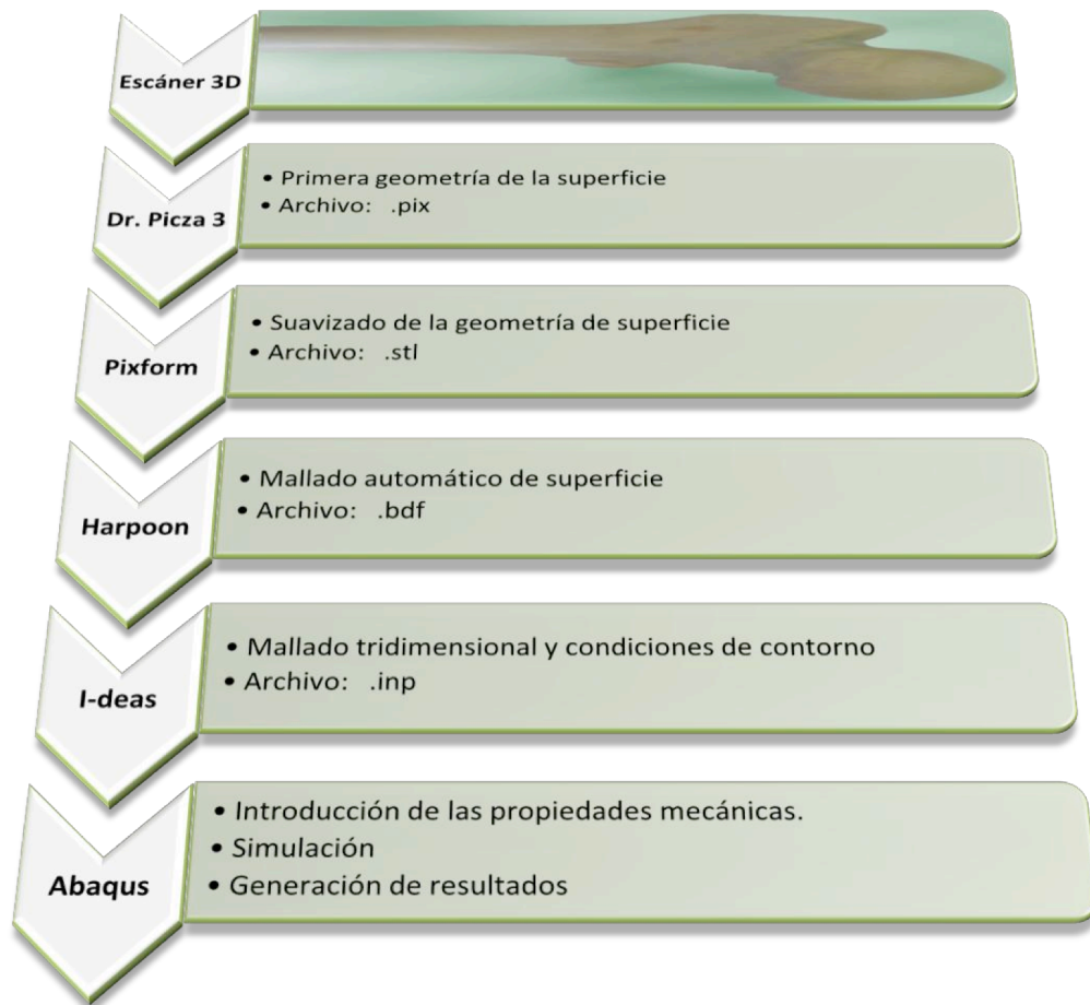
Figura 6: Diagrama de bloques que resume la metodología informática necesaria para realizar una simulación de elementos finitos. Junto al programa se indica la función realizada así como el tipo de archivo generado.
