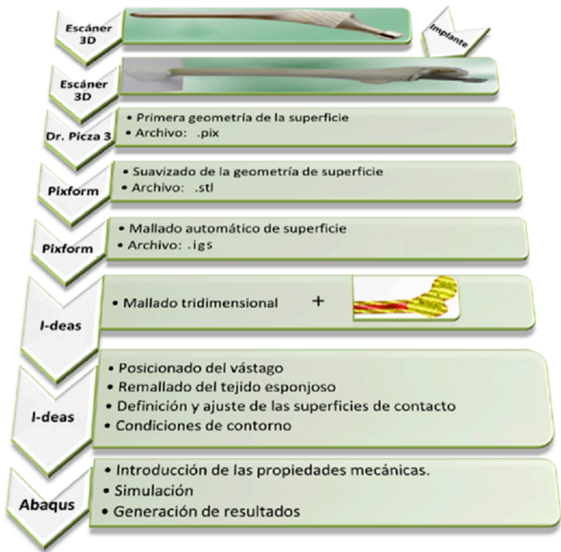
Figura 14: Diagrama que resume los procesos seguidos para generar el modelo de elementos finitos del fémur con el vástago VERSYS. Se indica el programa informático y su función principal.
