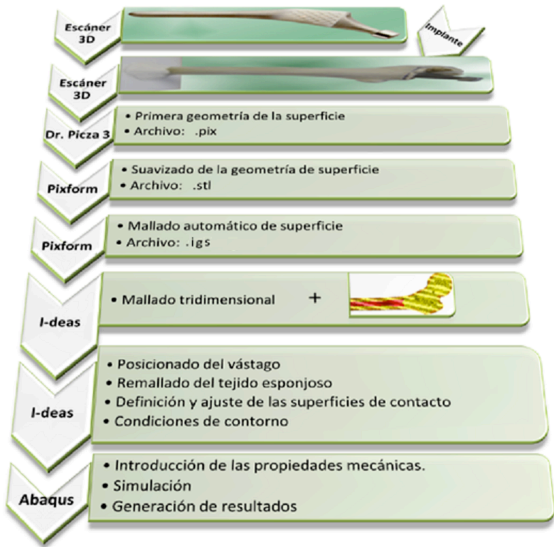
Figura 10: Diagrama que resume los procesos seguidos para generar el modelo de elementos finitos del fémur con el vástago ABG II. Se indica el programa informático y su función principal.
