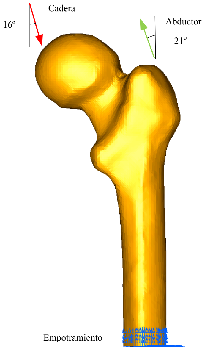
Figura 8: Condiciones de contorno del modelo de fémur sano.
