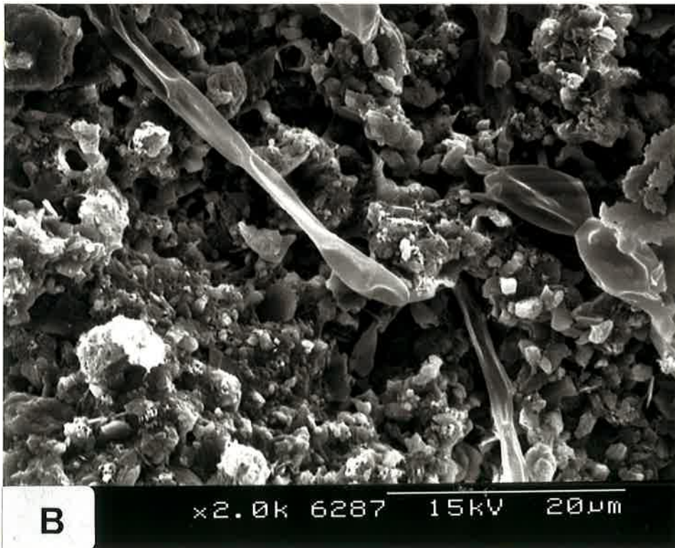
Figura 3.36.- A: Filamentos, posiblemente de hongos, dentro de una caliza estromatolítica. B: Detalle.
