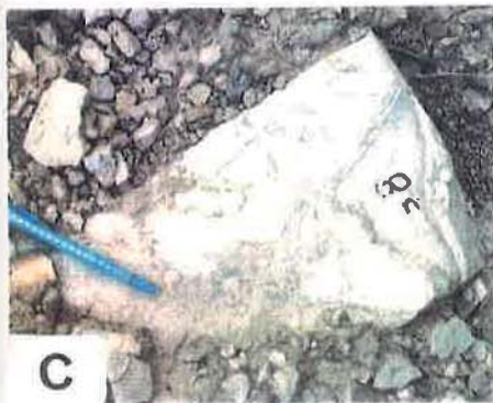
Figura 2.78.- A, B y C: Diferentes formas de aparición de la fisuración dentro de calizas laminadas.
