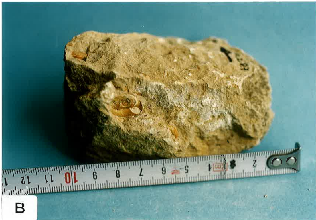
Figura 3.42.- Textura de la facies Cb. A: Wackestone de fragmentos fósiles, esencialmente gasterópodos. B: Wackestone de gasterópodos (enteros y rotos).
