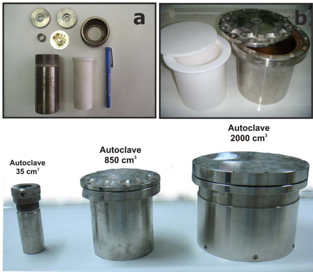
Ilustración 142: Fotografías de los distintos autoclaves utilizados en este trabajo para la síntesis hidrotermal de zeolitas
