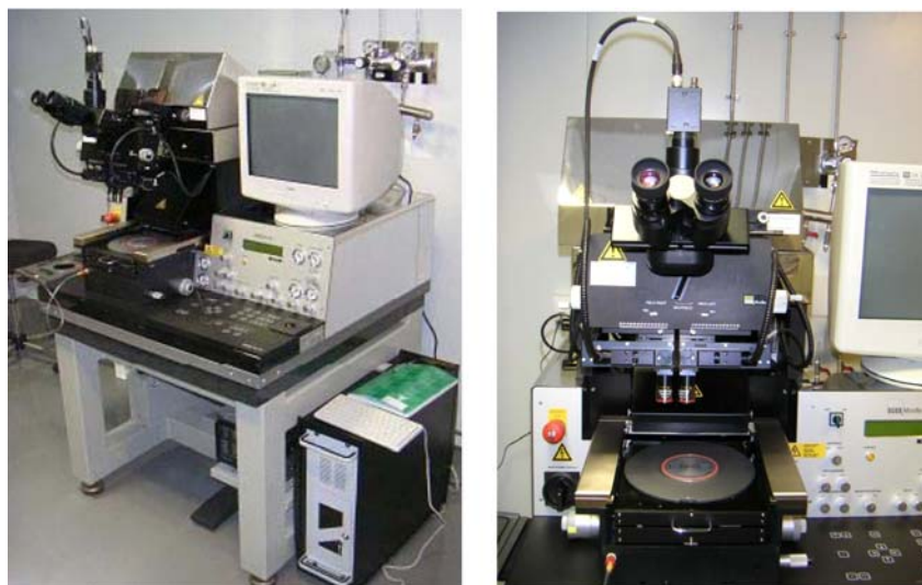
Ilustración 146: Fotografías de la estación de alineado situada en el interior de la sala blanca
