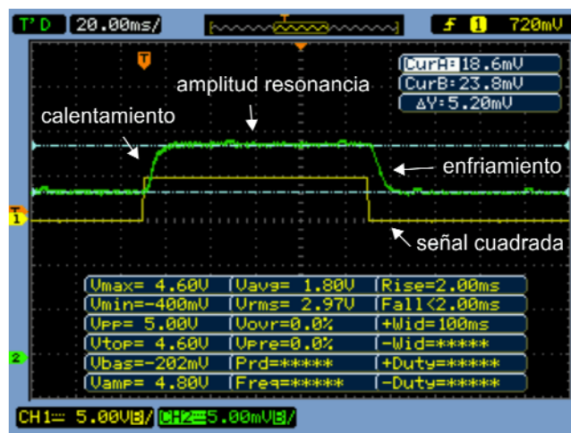
Ilustración 122: Variación periódica de la amplitud de la resonancia medida en el osciloscopio cuando se hace pasar por el calefactor una señal alterna de periodo 100 ms y voltaje 5 V.
