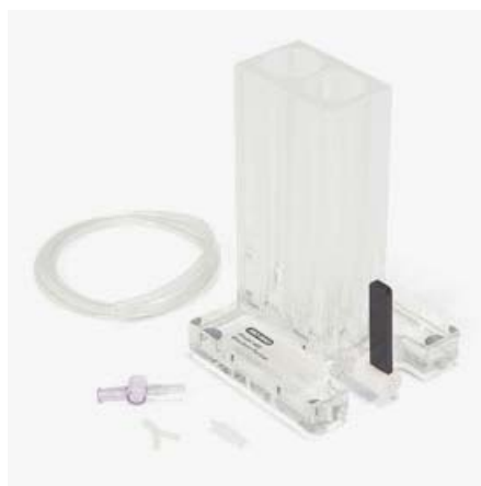
Figura VII.12: Ejemplo de formador de gradientes. La cámara de la izquierda es la cámara 1, en la que tendremos la mezcla del 15%, y la cámara 2 la de la derecha en la que añadiremos la mezcla de archilamida del 20%.
