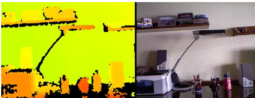
Figura 3.1: Escena RGB (derecha) y su mapa de profundidad asociado (izquierda). Los píxeles del mapa de profundidad de valor negro indican valores indeterminados. Estas zonas suelen encontrarse en objetos transparentes o que reflejan la luz, como en este caso el cristal que se encuentra encima de la mesa.
