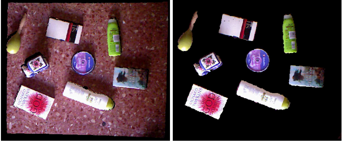
Figura 3.5: Eliminación de planos. A la izquierda la nube original, a la derecha la nube tras eliminar el plano del suelo.
