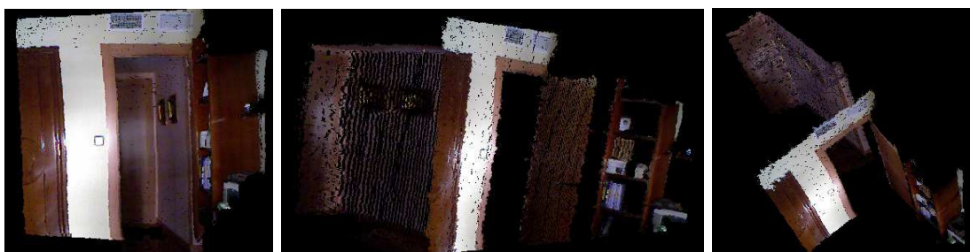
Figura 3.2: Distintas perspectivas de una misma nube de puntos. La imagen de la izquierda corresponde con el punto de vista original con el que se tomó la foto, mientras que las de la derecha representan rotaciones de dicha escena.
