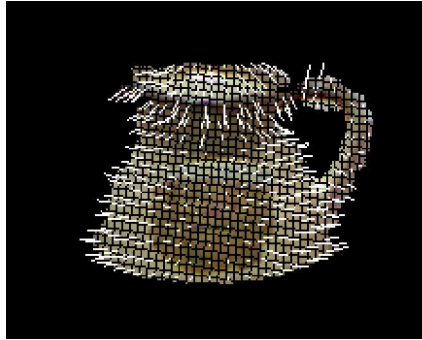
Figura 3.7: Representación de las normales de un objeto. El objeto, en este caso una jarra, se muestra como fondo y los vectores de color blanco representan la dirección de las normales en un subconjunto de los puntos de la nube.
