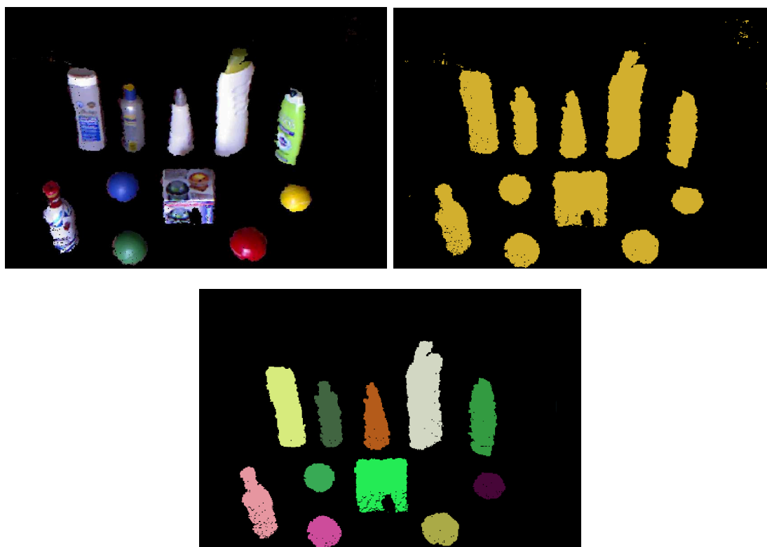
Figura 3.6: Proceso de clusterización de la escena. Arriba a la izquierda una escena tras la etapa de segmentación del plano. A la derecha la misma escena pero coloreada de un mismo tono para notar más claramente el ruido que queda tras eliminar el plano. Debajo, el resultado de agrupar la imagen, donde cada tonalidad representa un cluster distinto. Nótese que se ha eliminado el ruido, ya que forma clusters demasiado pequeños.
