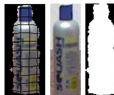
Figura 4.2: Datos de la nube de puntos tras la segmentación. De izquierda a derecha la nube segmentada, la imagen 2D mínima y la máscara.
