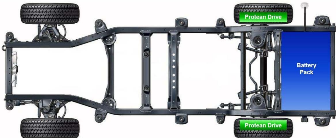
Figura 28. Disposición del tren de potencia en un vehículo eléctrico con motores rueda (7)
