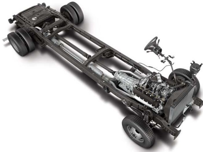
Figura 34. Bastidor y chasis de una furgoneta Ford Transit
