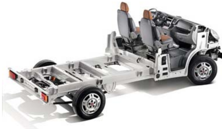
Figura 32. Chasis perteneciente a un vehículo de combustión de la clase N1
