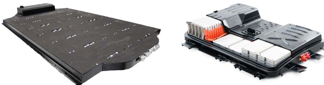
Figura 4. Baterías montadas en el Tesla Model S (izq.) y Nissan Leaf (dcha.) (8)
