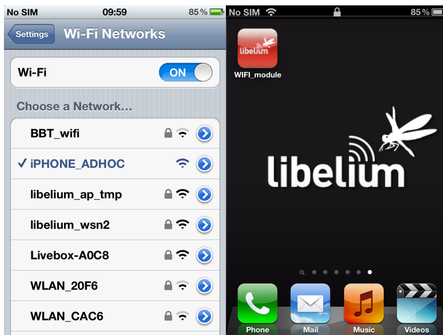
Figura 6.2: Conexión a la red del módulo Wi-Fi e icono de la iPhone App
