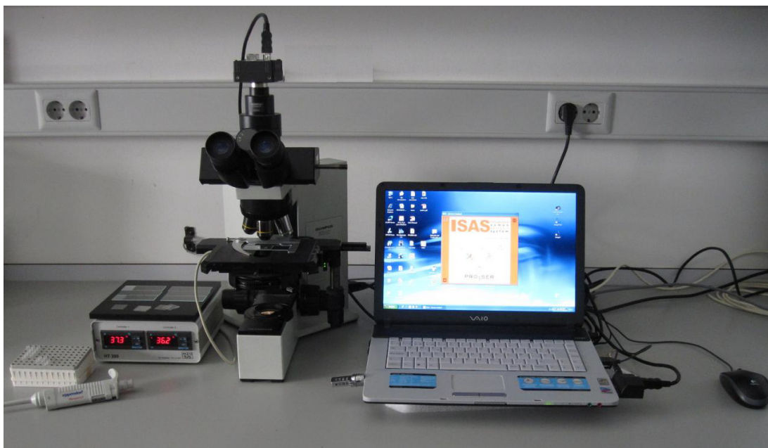
Figura 14. Sistema CASA para el análisis espermático compuesto por un microscopio óptico conectado a una platina atemperada, a una cámara de video y a un software de análisis de imágenes por ordenador.
