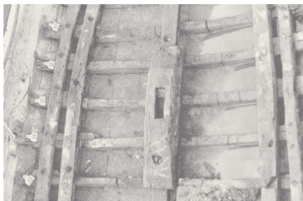
Figura 16.- Detalle de la situación de la carlinga sobre la sobrequilla y los dos pares de palmejares.
