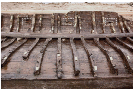
Figura 11.- Detalle del costado interior del YK 16, donde se aprecian los espacios para albergar las bancadas de voga.
