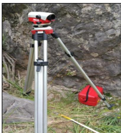
Foto 1: Nivel topográfico, mira telescópica y cinta métrica.
