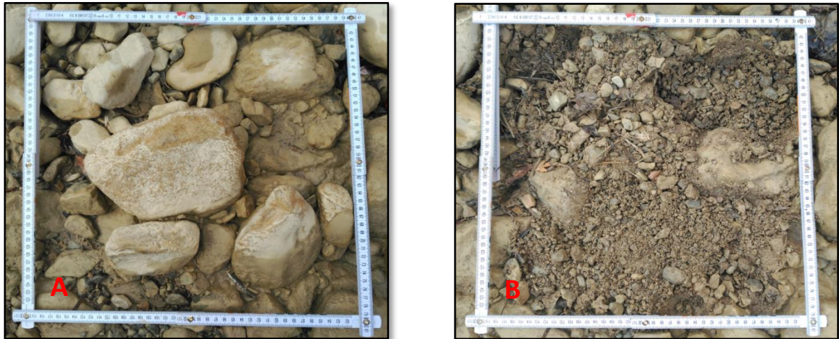
Figura 17: Capa superior e inferior del lecho fluvial en la sección Nueno
