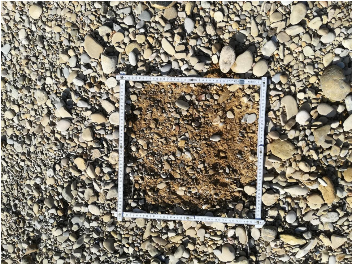
Figura 106. Acorazamiento del sedimento. Elaboración propia.
