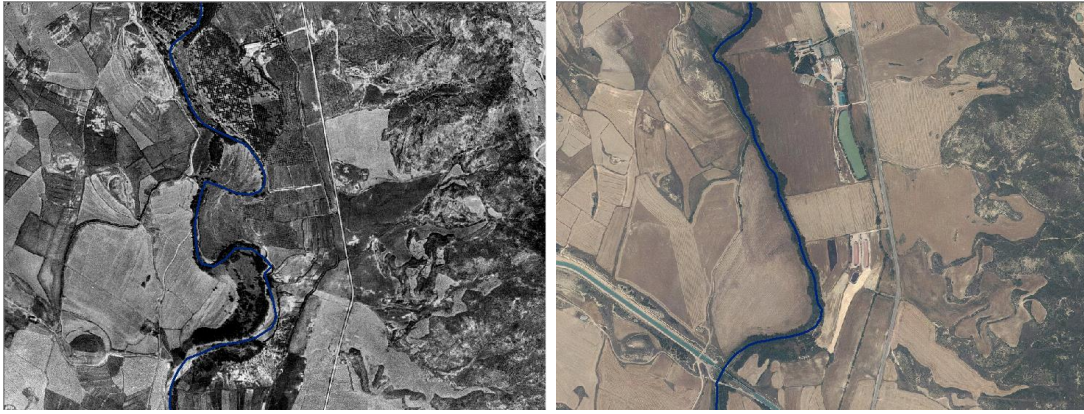
Figuras 65 y 66. Ejemplo de cambio de tipo morfológico en planta del río Arba de Biel aguas abajo de Luna. Tipo meandriforme (1956) a tipo recto (2015) por el efecto de los cambios de los usos del suelo y posiblemente por acciones directas sobre el cauce. Escala 1:10.000
