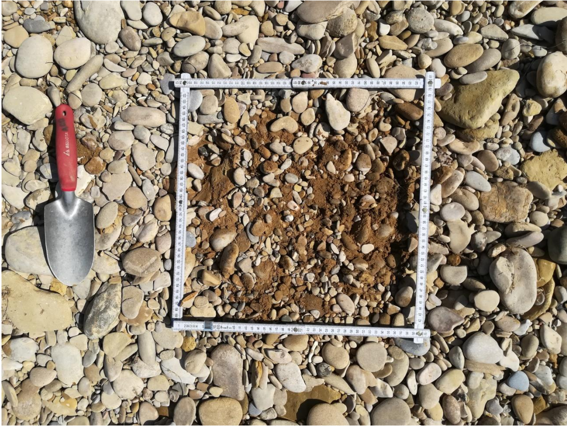
Figura 93. Acorazamiento del sedimento. Elaboración propia.
