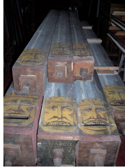
Tubos de los flautados con sus mascarones dibujados (izquierda) y tubos de flautado violón de 16' del pedal (derecha).
