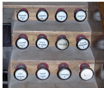
Detalle de los registros laterales de los teclados (partes izquierda y derecha respectivamente).
