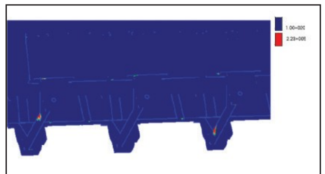
Fig. 10: Resultados obtenidos en el material base y las ZAT's de la cisterna en ciclos de carga. Detalle de la zona de eje
