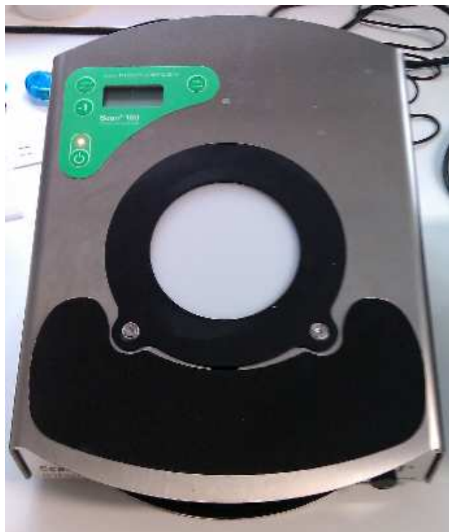
Figura 5.5. Contador de colonias (Interscience Scan 100)
