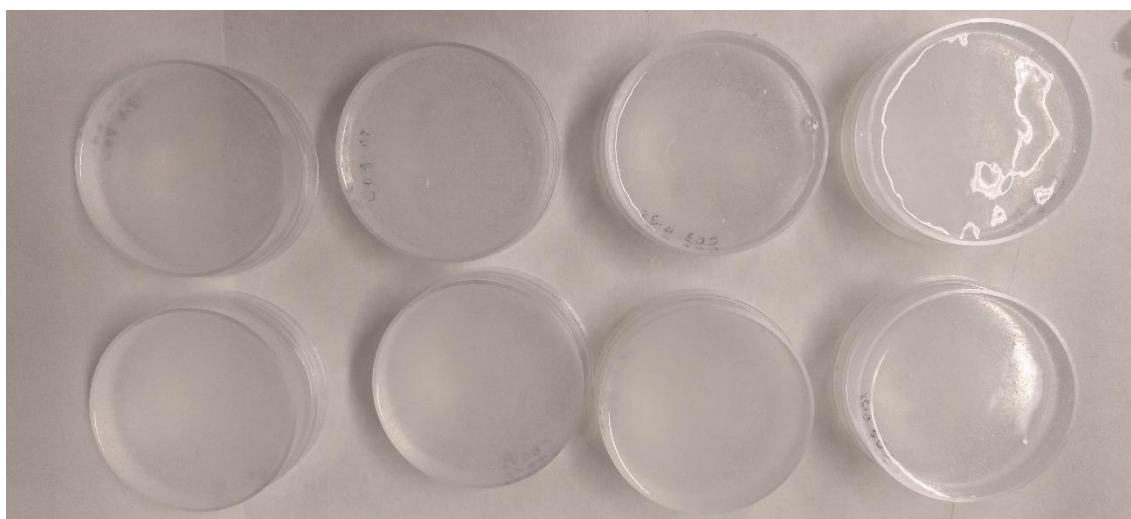
Figura 3. Disoluciones de CNF-LAE en placas de Petri de 55 mm, que deben dejarse secar a temperatura ambiente para conseguir la formación del film.
