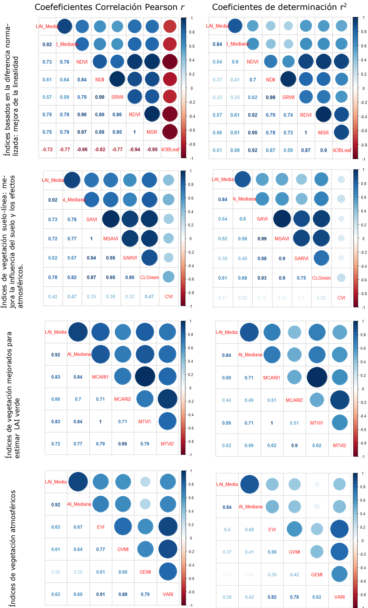
Figura 11. Análisis de Correlación de Pearson y Coeficientes de determinación para el Modelo A, sensor OLI
