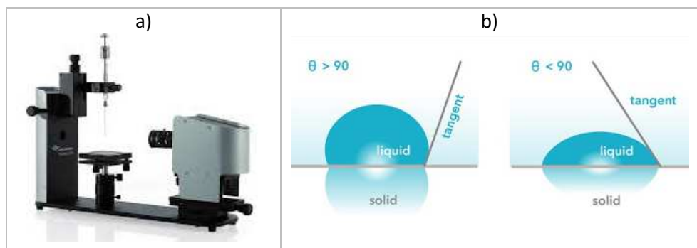
Ilustración 12. a) Goniómetro utilizado y b) Definición del ángulo de contacto estático.
