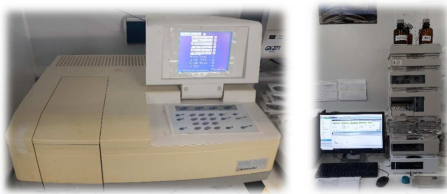
Figura 4. A la izquierda aparece el Espectrofotómetro Ultravioleta-Visible Shimadzu modelo UV-1700 y a la derecha el cromatógrafo de líquidos Agilent Technologies 1100.
