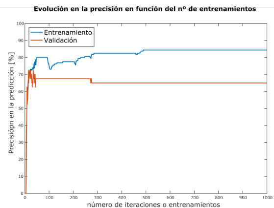
Figura III.5 Evolución de la precisión de diagnóstico para una arquitectura de dos capas de neuronas con 7 neuronas en la primera capa oculta, 1 neurona en la segunda y una razón de aprendizaje \alpha = 0.5 .
