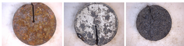
Figura 18. Muestra sin tratar (izquierda), tratada con láser IR (centro) y con láser UV (derecha).
