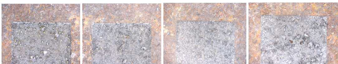
Figura 14. Aspecto de la superficie de la pieza de acero tras haber sido tratada con el láser de n-IR con una frecuencia de 400 kHz, una potencia de 8 W y un interlineado de 15 micras y a diferentes velocidades de barrido (mm/s) 25, 50, 75 y 100, de izquierda a derecha.
