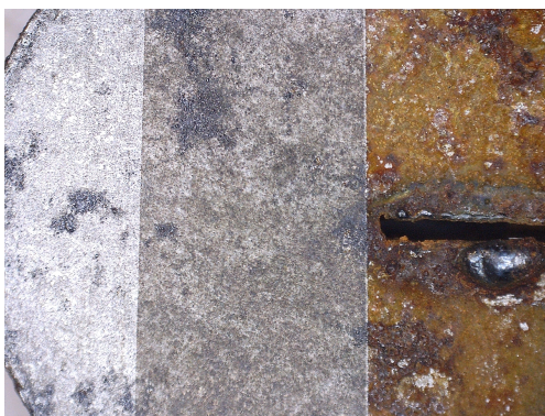
Figura 29. Tratamiento láser IR+UV (izquierda), tratamiento láser IR (centro) y región sin tratamiento (derecha).
