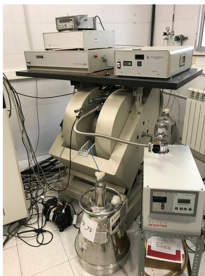
Figura A.2: Dispositivo de EPR modelo Elexsys E-580 de la corporación Bruker.
