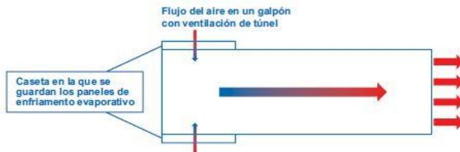
**Figura 1:** Flujo de aire en ventilación tipo túnel Fuente: Fuente: Ross, Manual de manejo 2014
