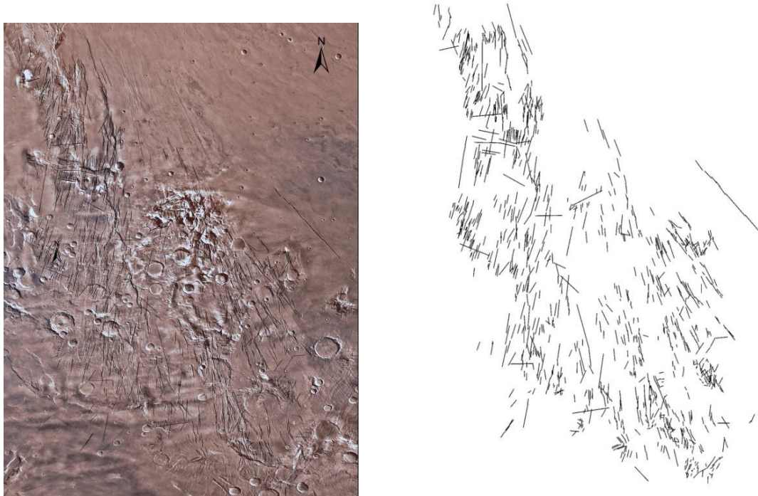
Figura 9: Visualización de las estructuras reconocidas en la zona. A la izquierda se sitúa el mapa de las mismas sobre la imagen obtenida por la sonda Viking.
