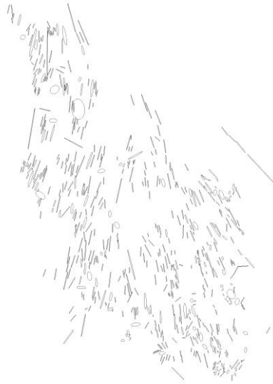
Figura 10: Representación de las elipses obtenidas a partir del ImageJ. Esta imagen da una idea de cuáles son los datos que ha analizado finalmente.
