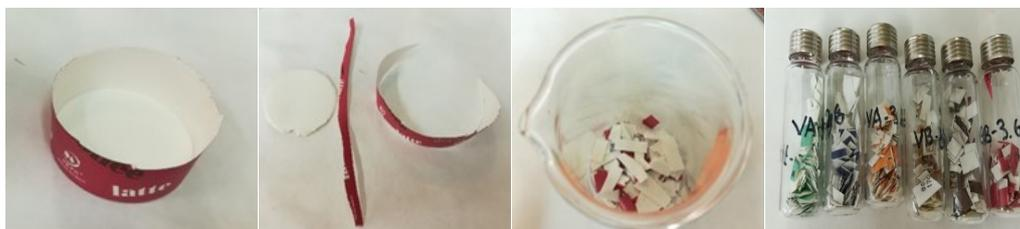
**Figura 5.** Preparación de las muestras de vasos de cartón para el análisis de volátiles.
