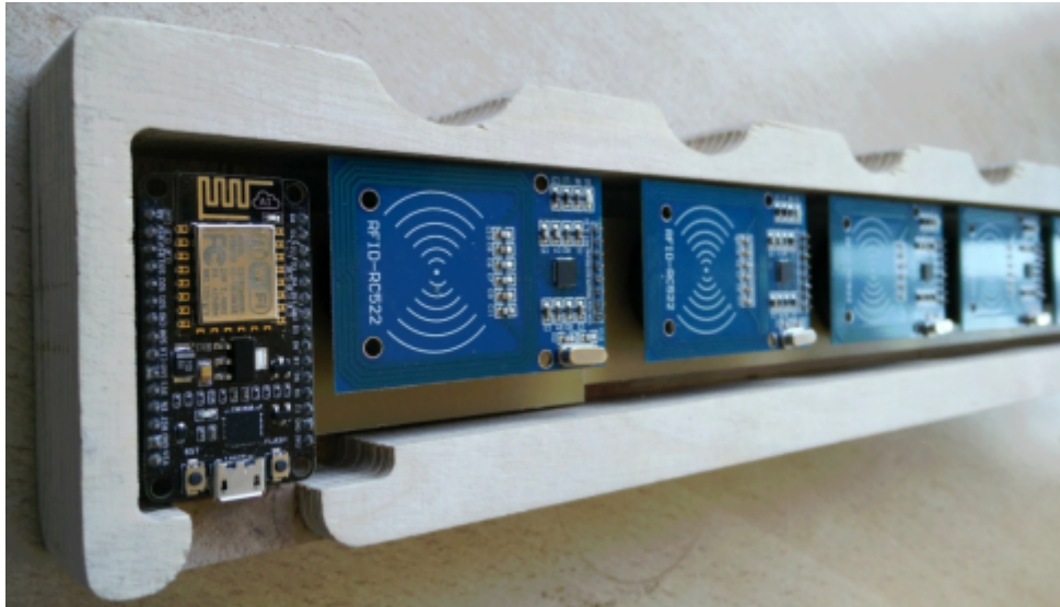
Ilustración 10: En esta imagen se puede apreciar otro prototipo. En este caso se trata de un dispositivo con 7 bahías montadas sobre una PCB.
