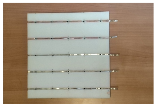
Pegado de diodos en Voscoelástica
