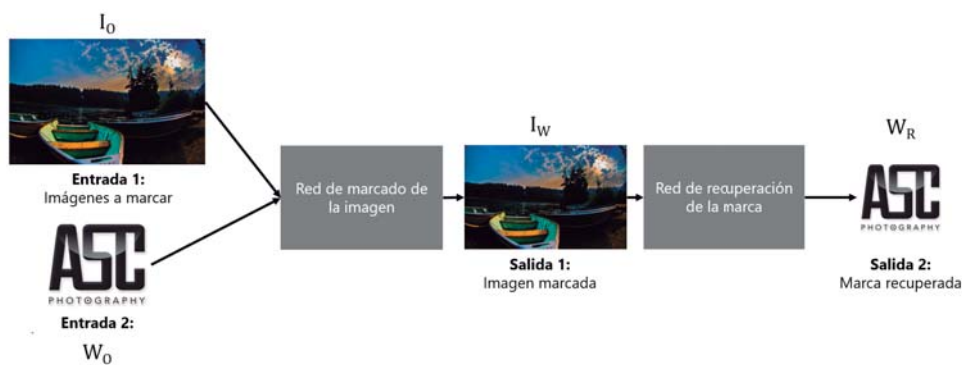
Figura 3.3: Esquema del marcado de agua con una única marca.
