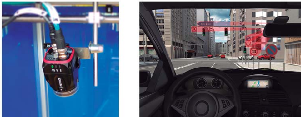
Figura 1.3: Dos distintos ejemplos de aplicaciones de la visión por ordenador. A la izquierda una cámara de vision usada como Poka-Yoke en un sistema productivo. A la derecha un ejemplo de reconocimiento de señales en un vehículo.
