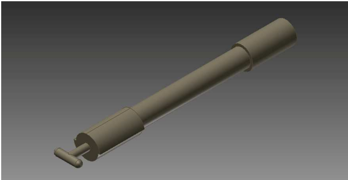
Figura 2.4. Cilindro de diámetro variable
