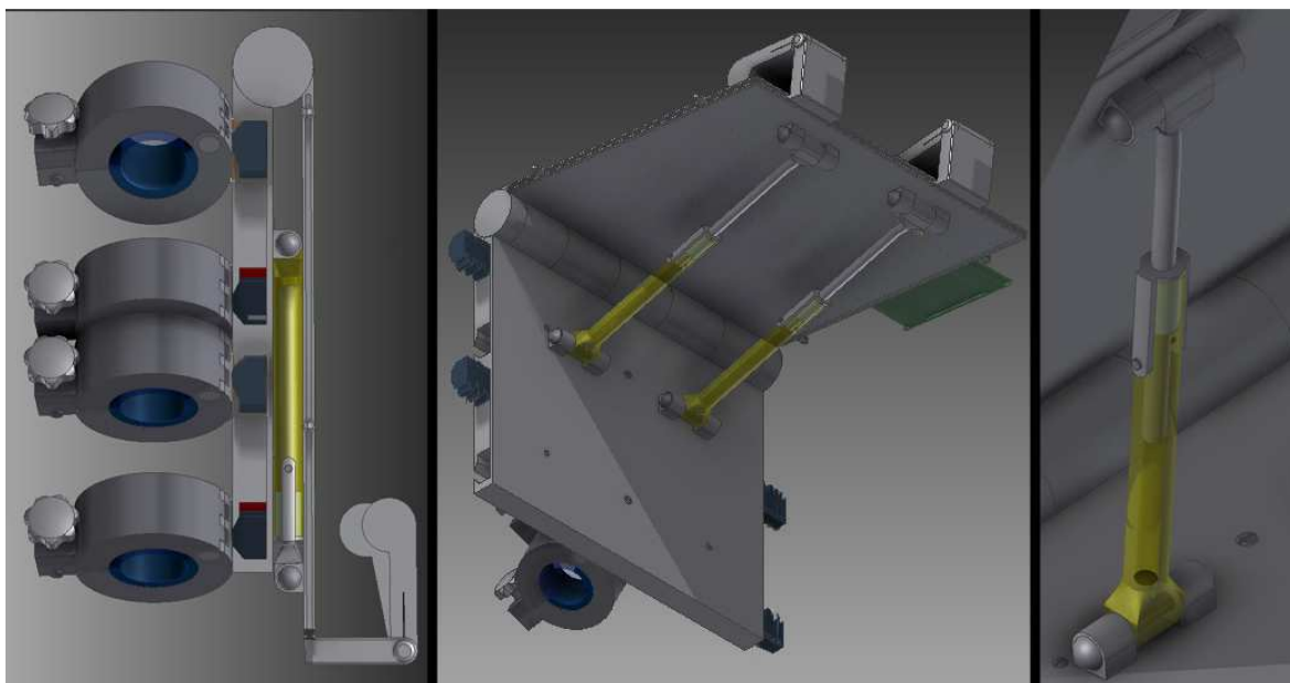
Figura 4.3 Sistema de elevación, tercera opción. Sección circular
