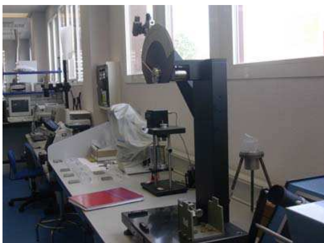
Figura 15. Péndulo para ensayos Izod.
