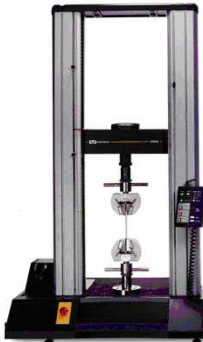
Figura 11. Máquina Instron 5565, utilizada para ensayos de tracción y compresión.
