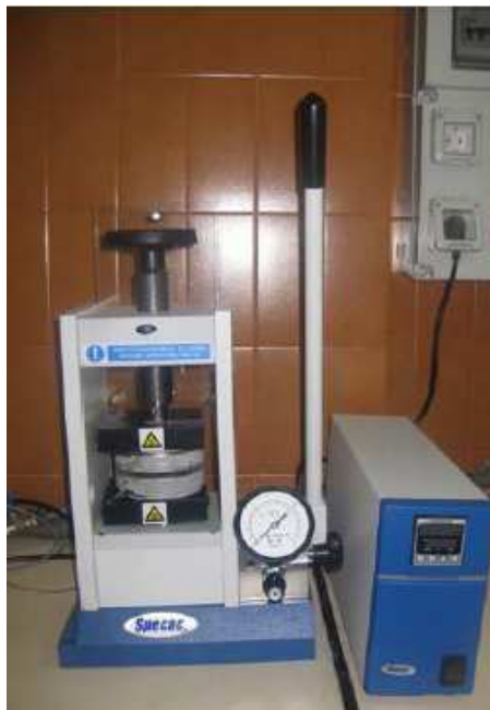
Figura 10. Prensa hidráulica utilizada para realizar el termoconformado.
