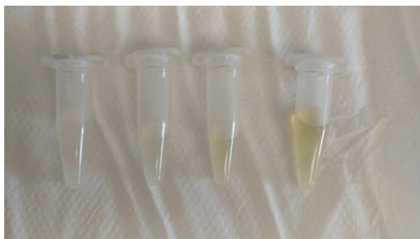
Figura 4. Dispersiones de AgNPs de concentraciones (de izda. a dcha.) 2,5; 5; 10 y 20 ppm, en una calibración típica.
