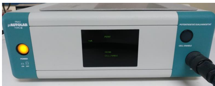
Figura 1. Potenciostato \mu Autolab FRAD2 TYPE III empleado en las medidas voltamétricas de este trabajo.
