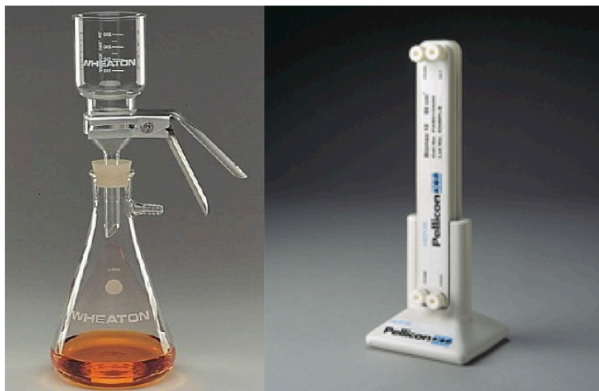
Figura 4.3. Equipo de filtración al vacío y concentrador. A la izquierda, sistema de filtración al vacío. A la derecha, concentrador Pellicon XL Biomax.
