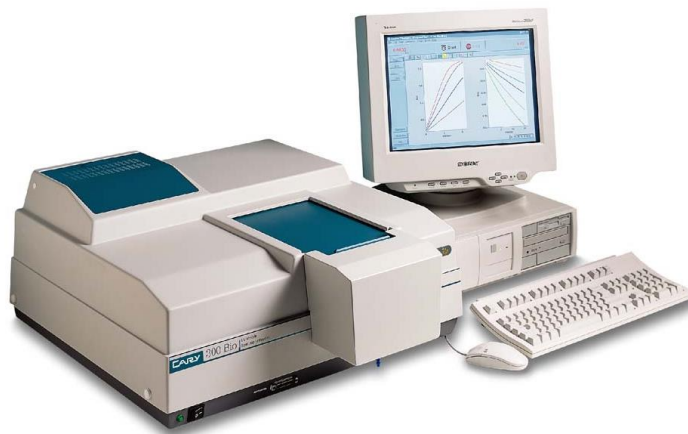
Figura 4.14. Espectrofotómetro UV-Vis. Espectrofotómetro Cary (Varian) utilizado para la obtención de espectros UV-Vis a lo largo de esta tesis.
