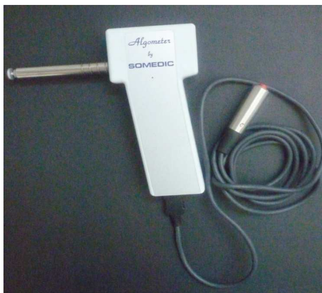
Figura 17. Algómetro digital Somedic AV Fastra.
