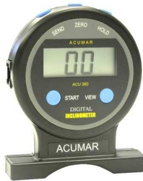
Figura 14. Inclinómetro digital Acumar™ versión 5.0.
