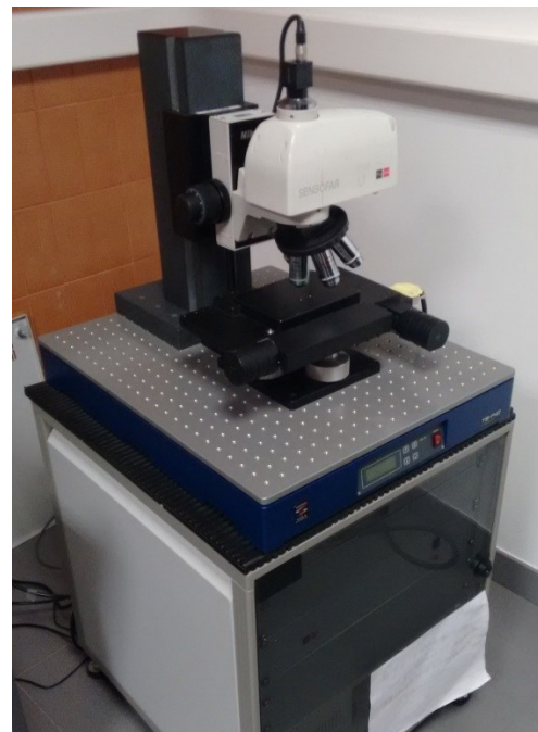
Figura 2.15 Representación esquemática del funcionamiento de un perfilómetro confocal (izda.), fotografía del perfilómetro confocal Sensofar PL \mu 2300 (dcha.).
