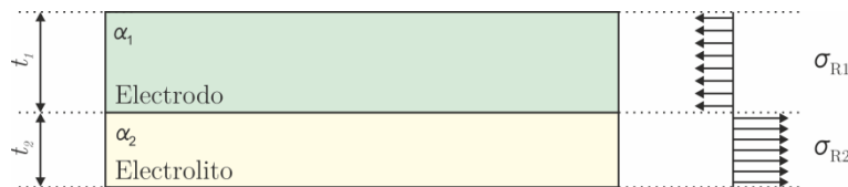
Figura 4.4 Representación de las tensiones originadas por la contracción diferencial de dos placas adheridas.
