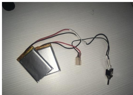
Figura 3.3: Baterías recargables usadas. Se añade un interruptor general para apagar y encender el sistema.
