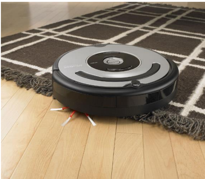
Figura 5. Situación que da error a la odometría.
