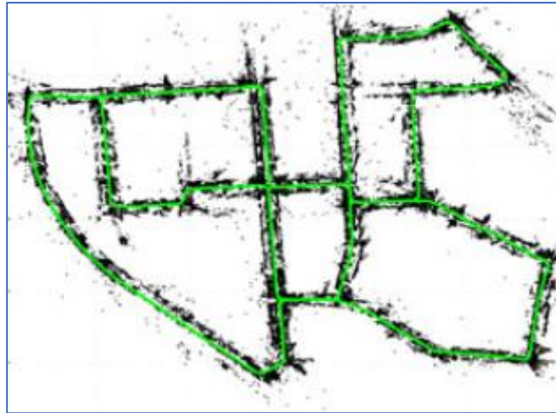
Figura 4 - Mapa y trayectoria generada por ORB-SLAM2 en la secuencia KITTI 00
