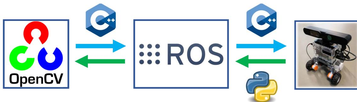
Figura 2.6: Esquema de alto nivel del software utilizado en el proyecto. El *node* de detección de vehículos (basado en OpenCV) está escrito en C++, al igual que el *node* de SLAM. Mientras que el *node* de control del movimiento está escrito en Python.
