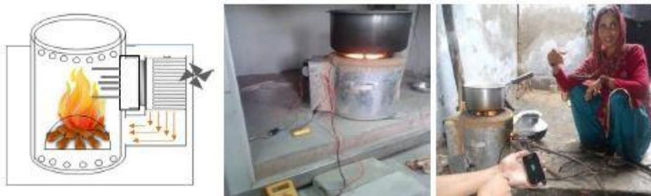
Figura 4 - (a) Esquema de una cocina-estufa; (b) Prueba en condiciones de laboratorio; (c) Carga del teléfono móvil por el TEG integrado en la estufa-cocina
