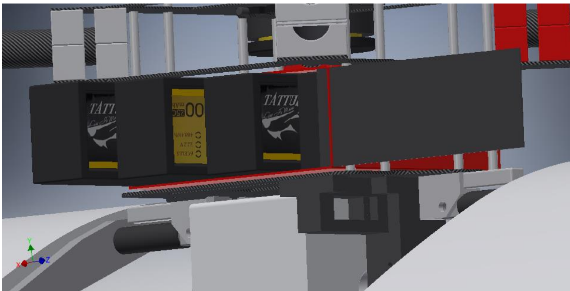
Figura 122: Carcasa wáter proof para baterías. Colocación de las baterías en la aeronave. Fuente: Elaboración propia.
