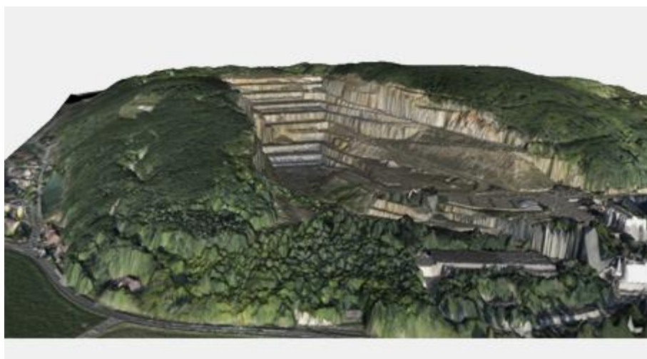
Figura 45: Mapa 3D creado a partir de nube de imágenes georeferenciadas tomadas por un drone. Fuente: Brantax.
