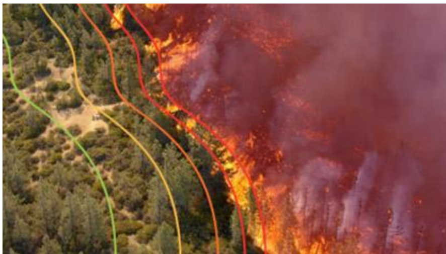
Figura 57: Previsión del avance del frente del fuego en un incendio forestal mediante una imagen captada por un drone. Fuente: ADTS Group.
