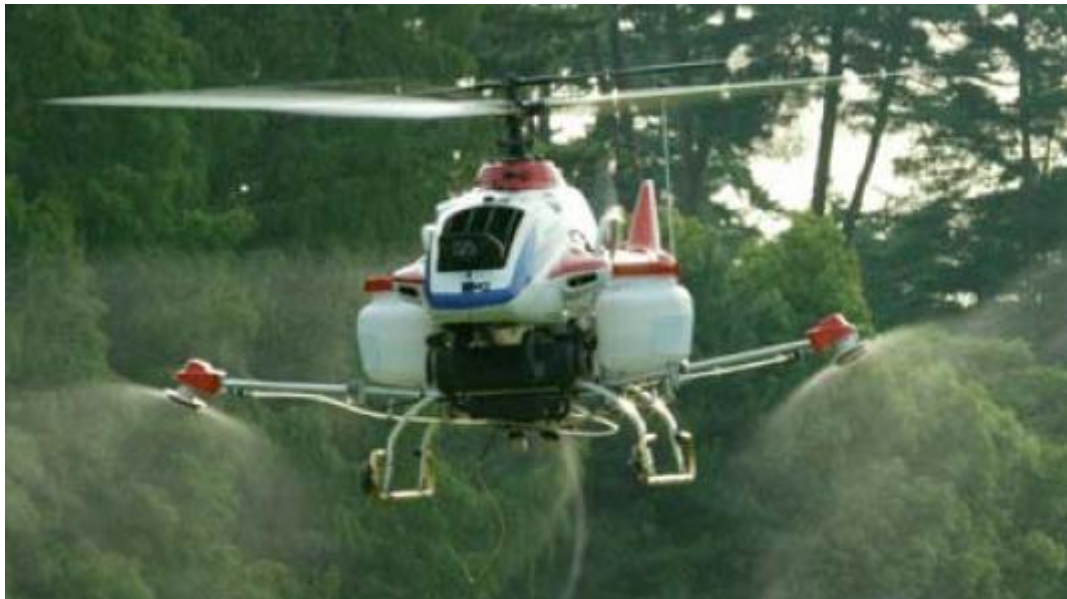
Figura 38: Helicóptero R-Max aplicando fertilizante mediante un sistema de dos pulverizadores. Fuente: Dronelife.com
