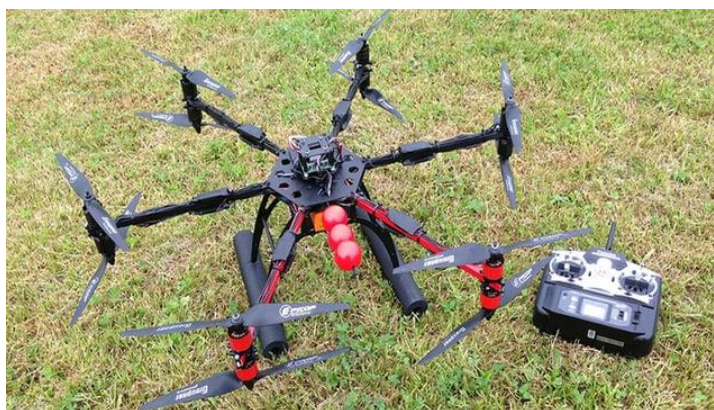
Figura 22: Dodecacóptero co-axial. Fuente: RCgroups.com
