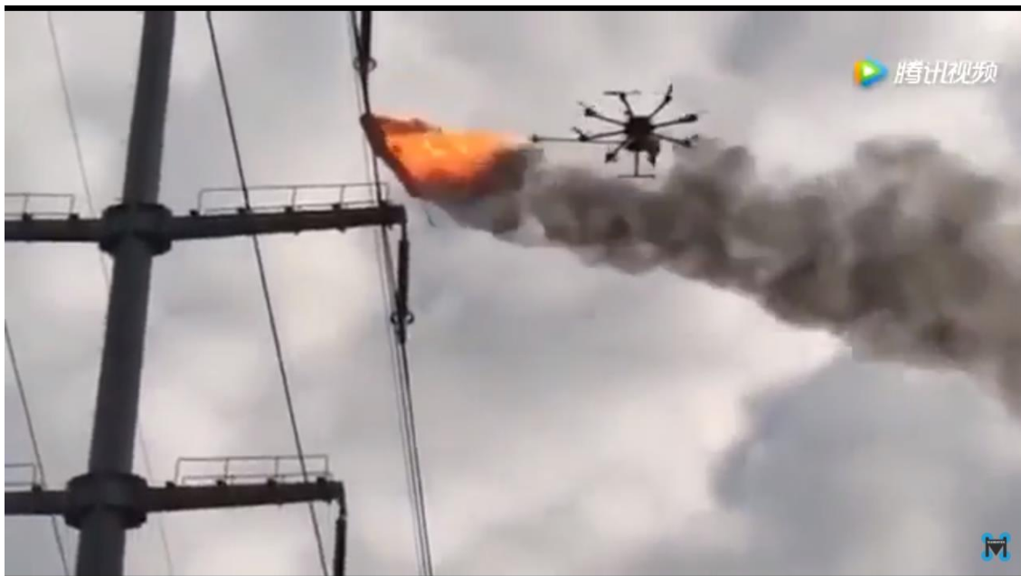
Figura 58: DJI S1000 con sistema lanzallamas retirando un trozo de plástico enganchado en una torre de alta tensión. Fuente: Beem Tech Technology.
