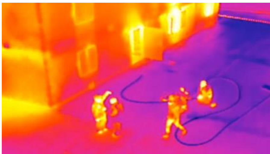
Figura 56: Cámara termográfica incorporada en un dron visualizando las labores de extinción de bomberos en un incendio de un edificio. Fuente: DJI
