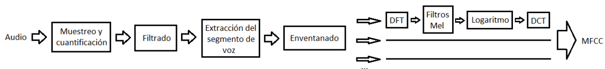
Figura 2.2: Esquema del análisis de la señal para la extracción de los MFCC.
