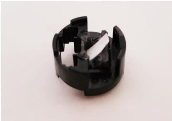
Figura 8: Fotografía del sensor modificado donde se encuentra el soporte con los NCs inmovilizados
