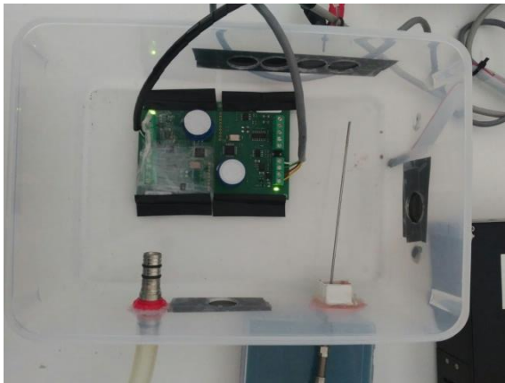
Figura 7: Fotografía del dispositivo casero de medida formado por el sensor comercial, la sonda y nuestro sensor.
