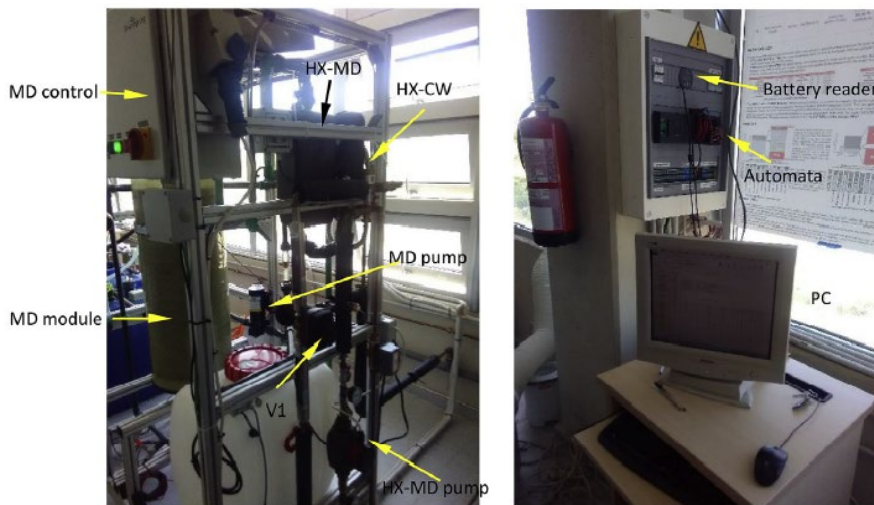
Figura 8. Detalle del sistema MD (izq.) y de los equipos de control (dcha.) [16].
