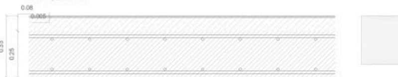
S3 Pavimento continuo de microcemento en planta baja-espacio público. Microcemento fino de 5mm aplicado sobre una capa de grueso. Para mejorar la adherencia entre el acabado y la capa homigrón aligerado, y aumentar la durabilidad del pavimento, se coloca una malla de fibra de vidrio. Superficie resistente e impermeable de escaso mantenimiento. Acabado microcemento SikaDecor 801 Nature 2. Color plata e=5mm
