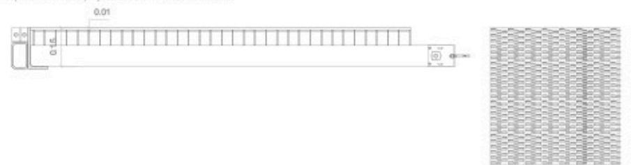
S4 Chapa de acero inoxidable Italfim Collection T163 sobre malla de seguridad RELESA en los espacios exteriores proyectados como terraza de vivienda.
