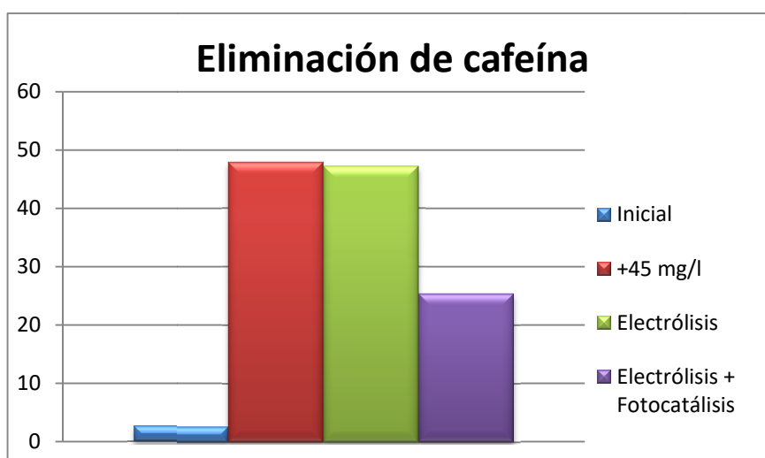
Figura 37. Concentración de cafeína inicialmente y tras añadir 45 mg/l en la muestra de agua de salida de depuradora fortificada con cafeína y bacterias, y su reducción tras tratamientos. [Cl_2]=1,6 mg/l.
